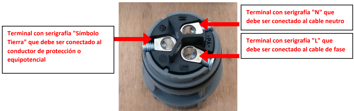
Figura 57– Indicaciones de cableado enchufe de línea eléctrica "EPS BACK-UP"
