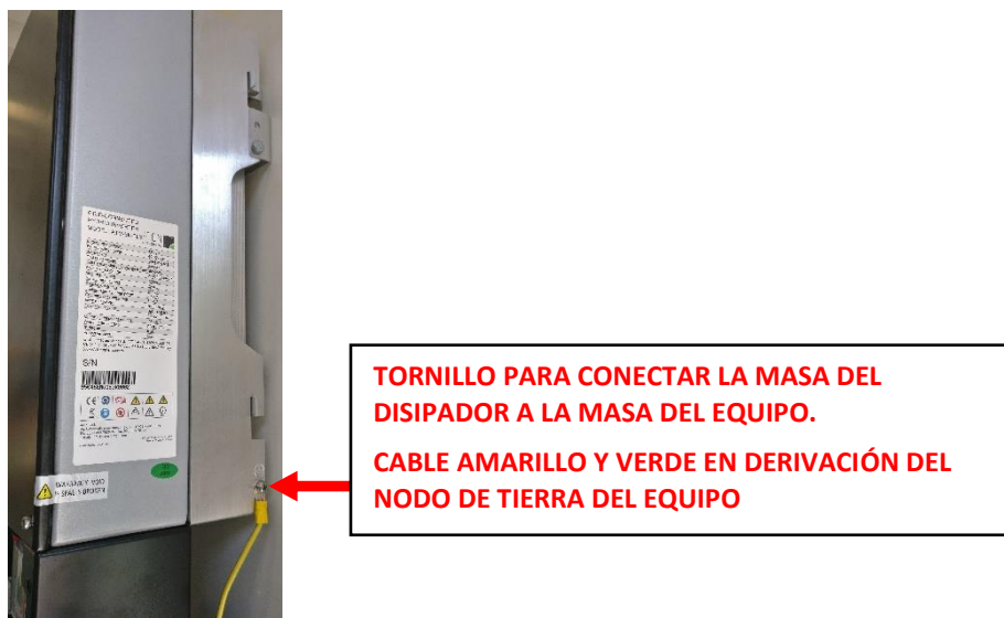
Figura 41 - Conexión entre el nodo de tierra del equipo y la masa del disipador
