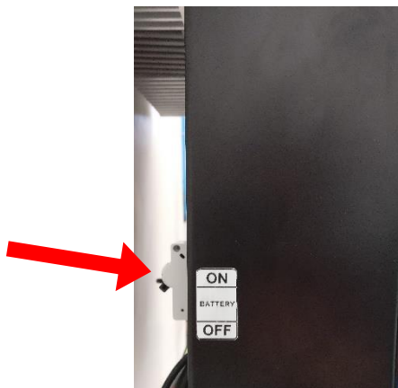
Figura 36 - Posición donde el interruptor de la parte posterior del inversor debe encontrarse
