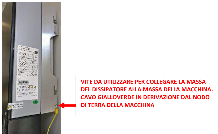
Figura 42 - Collegamento tra il nodo di terra della macchina e la massa del dissipatore
