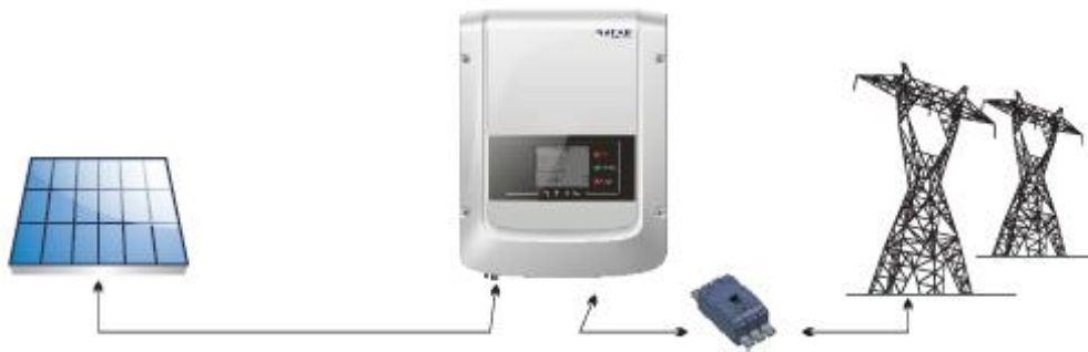
Figura 2 - Equipo fotovoltaico conectado a la red
