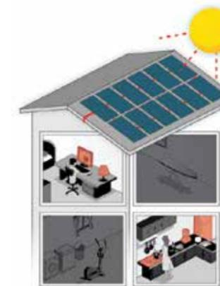
Durante el día: Las cargas importantes son alimentadas primero por el sistema FV y, después, por la batería. La batería puede cargarse a través del sistema FV siempre que sea necesario.
