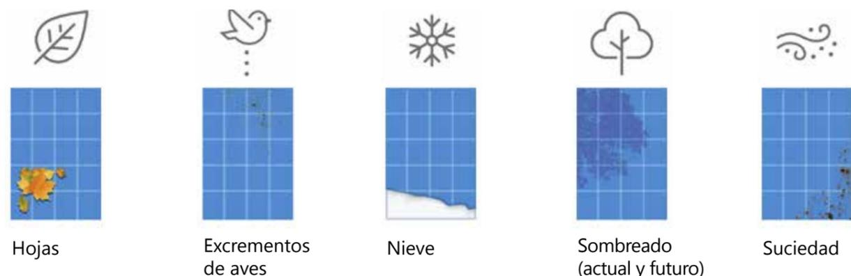
Con los inversores tradicionales, el módulo más débil reduce el rendimiento del resto de módulos. Con SolarEdge, cada módulo produce la máxima energía y se eliminan las pérdidas de potencia.
