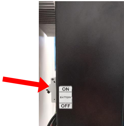
Figura 37 - Posición en la que debe ubicarse el interruptor en la parte posterior del inversor
