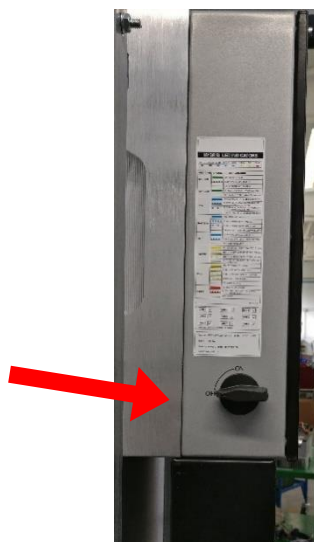
Figura 38 - Posición en la que debe encontrarse el interruptor en el lado izquierdo del artículo ATM-xK-TL
