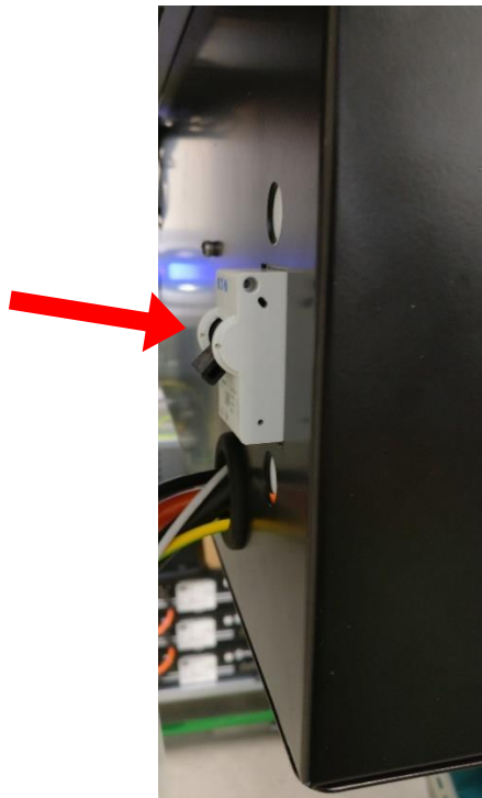
Figura 83 - Baje la palanca del interruptor QB1 para activar el M.Store
