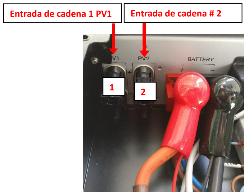
Figura 52 - Conexión conectores MC4
