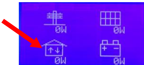
Figura 79 - Verificación de la comunicación activa con el portal Aton
