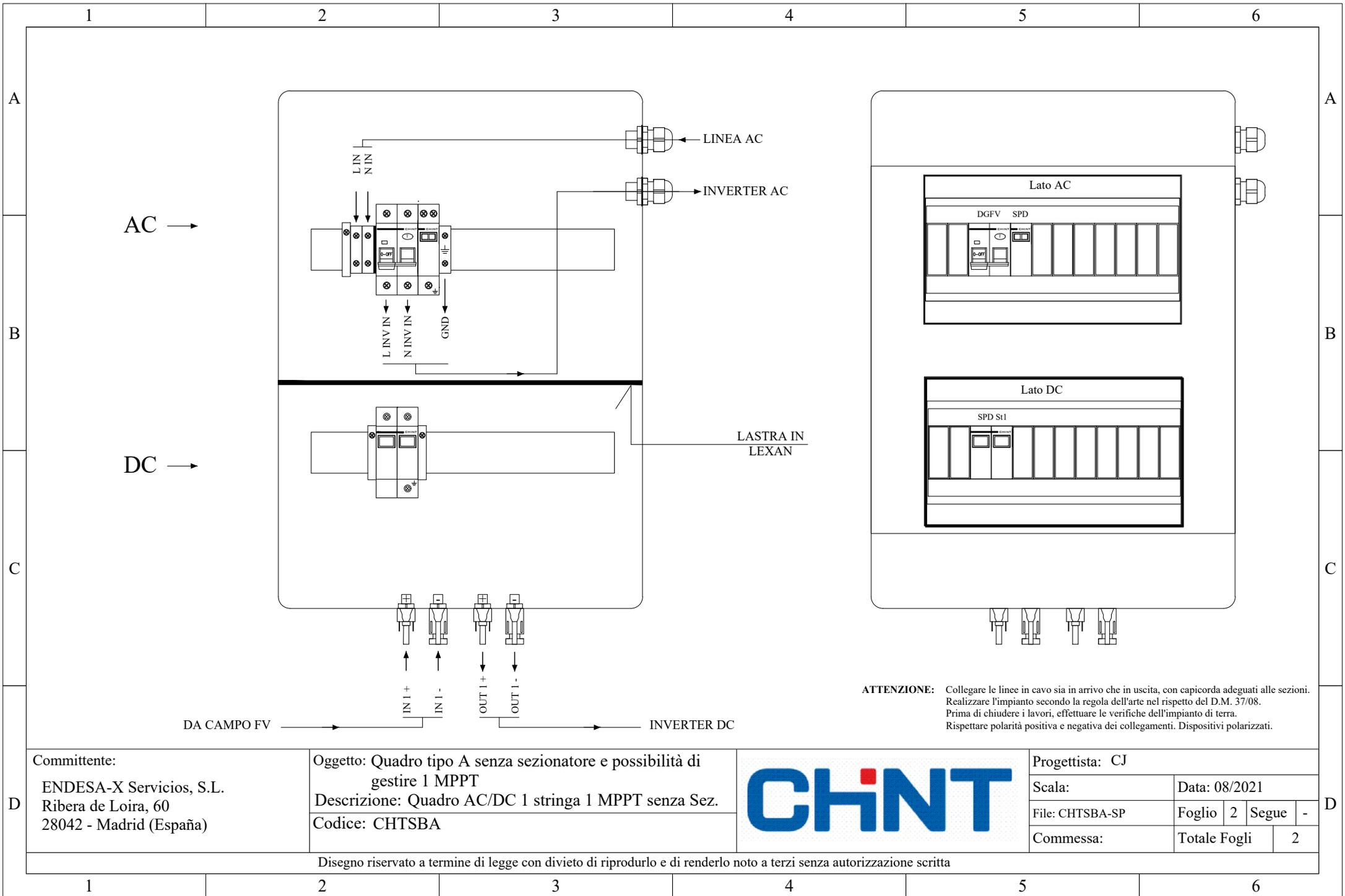
**ATTENZIONE:** Collegare le linee in cavo sia in arrivo che in uscita, con capicorda adeguati alle sezioni. Realizzare l'impianto secondo la regola dell'arte nel rispetto del D.M. 37/08. Prima di chiudere i lavori, effettuare le verifiche dell'impianto di terra. Rispettare polarità positiva e negativa dei collegamenti. Dispositivi polarizzati.
